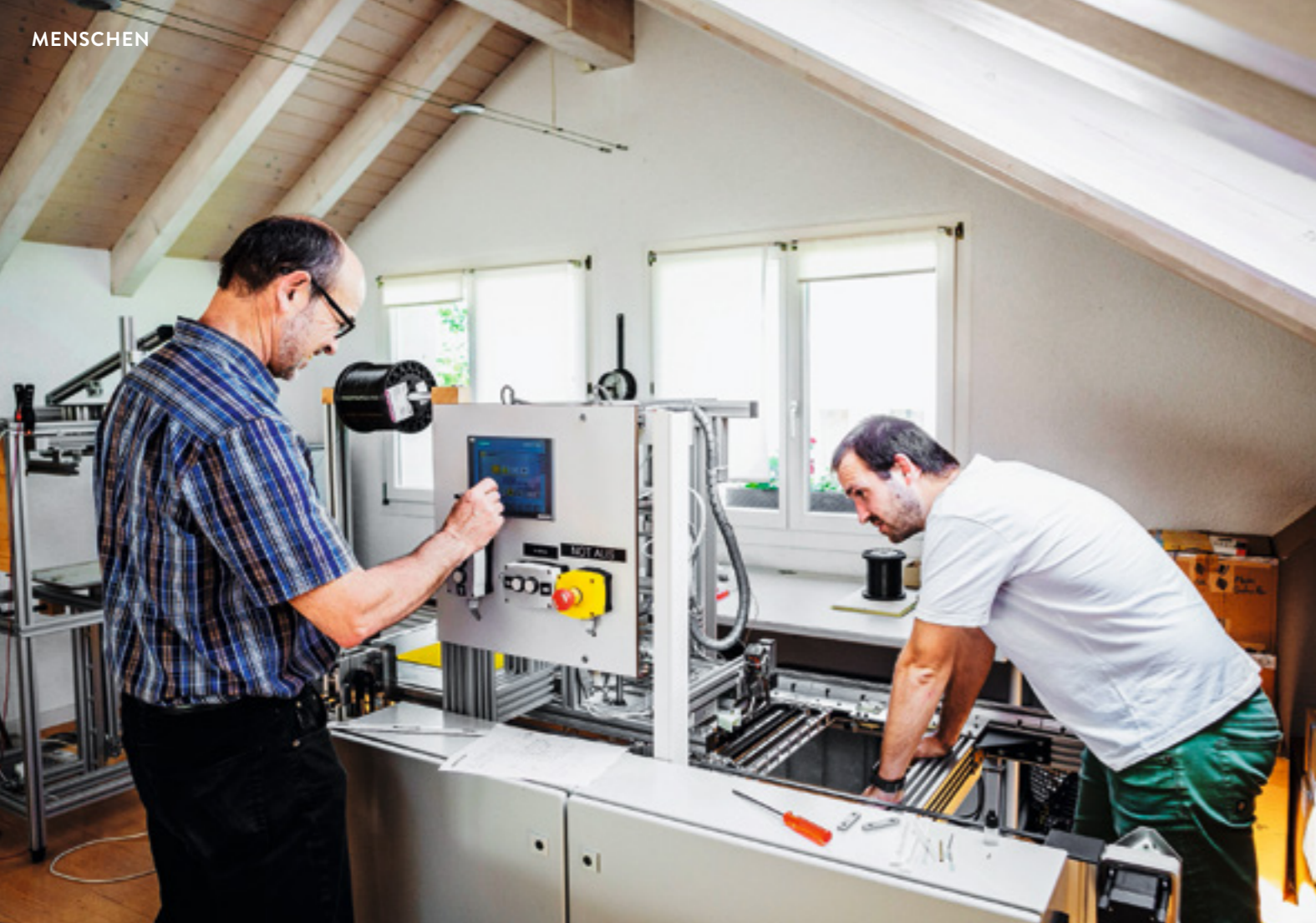
Mit ihrer selbst konzipierten Maschine schmelzen Vater und Sohn den spiralförmigen Heizdraht in die Wachsplatten ein.
