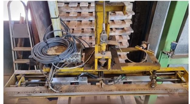
Bild: Cyltronic Elektrozyylinder montiert
