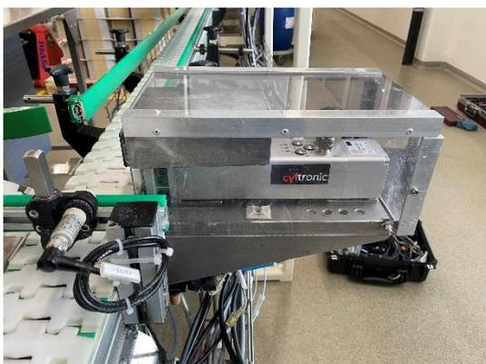
Bild: Cyltronic Elektrozyylinder montiert
