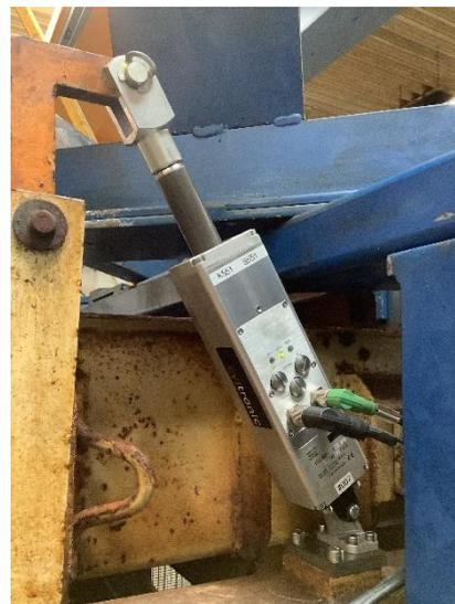
Bild: Cyltronic Elektrozyylinder montiert
