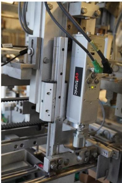
Bild: Cyltronic Elektrozyylinder montiert
