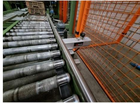
Bild: Cyltronic Elektrozyylinder montiert
